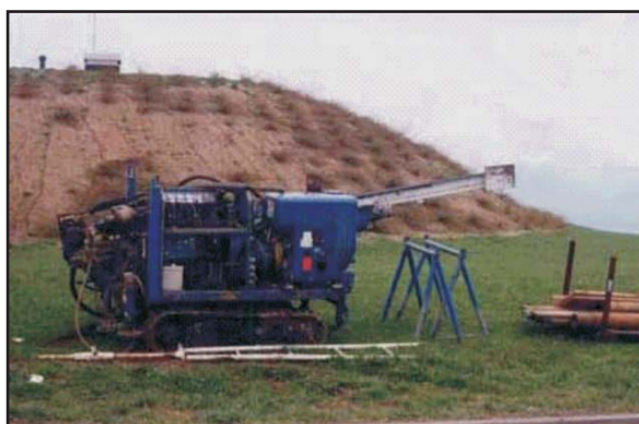
Fig. 6. Machine Wirth sur chenilles avec mât replié et préparé pour le retour au chantier
