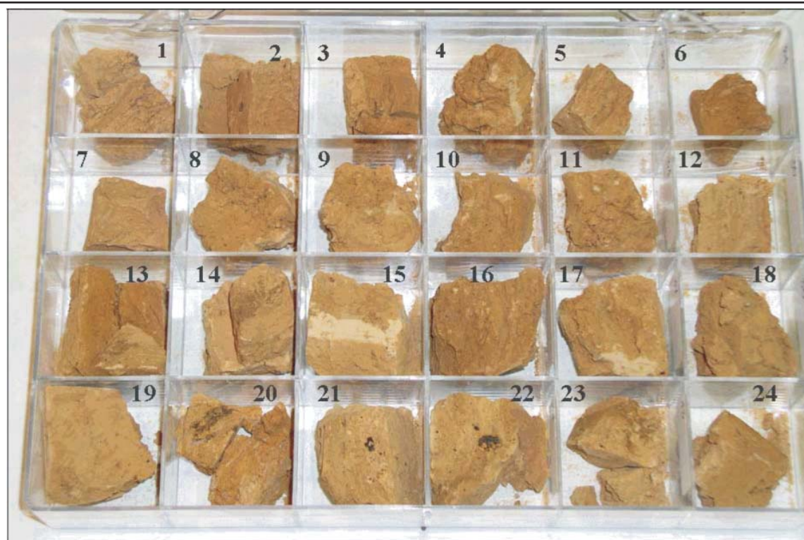
Fig. 13. Caisse avec des échantillons de référence. Les échantillons sont gardés en laboratoire et permettent des vérifications à chaque étape de l'étude et contrôles ultérieurs. Ils constituent des coupes de références de grande valeur accessibles à d'autres chercheurs; ils facilitent aussi des comparaisons et des corrélations avec des dépôts similaires
