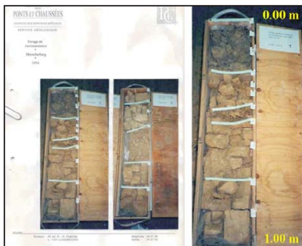
Fig 10. Représentation photographique des carottes de forage a, pièces du dossier, b, caisse 1 à un compartiment, passe de forage de 0.00-1.00 mètres, la récupération au forage n'est pas toujours parfaite et on a observé une perte de carotte à 6 mètres lors du changement de diamètre de forage
